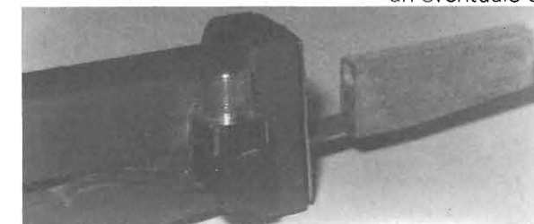
Particolare dell'assemblaggio del pulsante di comando della elettrovalvola sul corpo del Jolly.
